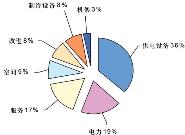
图 2 高可用性 2N 数据中心中典型机架 TCO 成本组成
