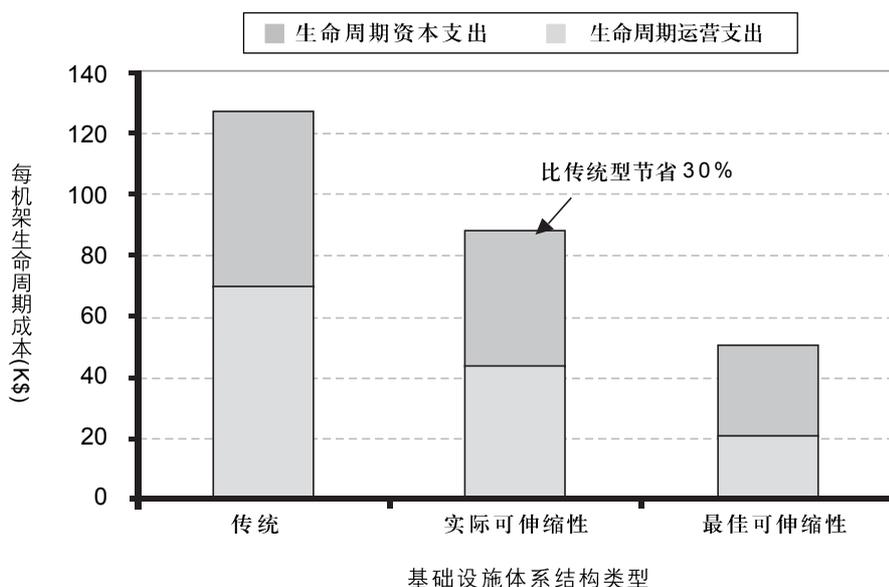
图 3 三类典型数据中心和网络机房基础设施的每机架生命周期成本
