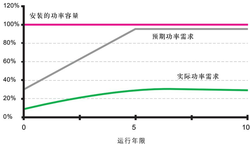
图1 整个生命周期中数据中心供电基础设施的利用率
