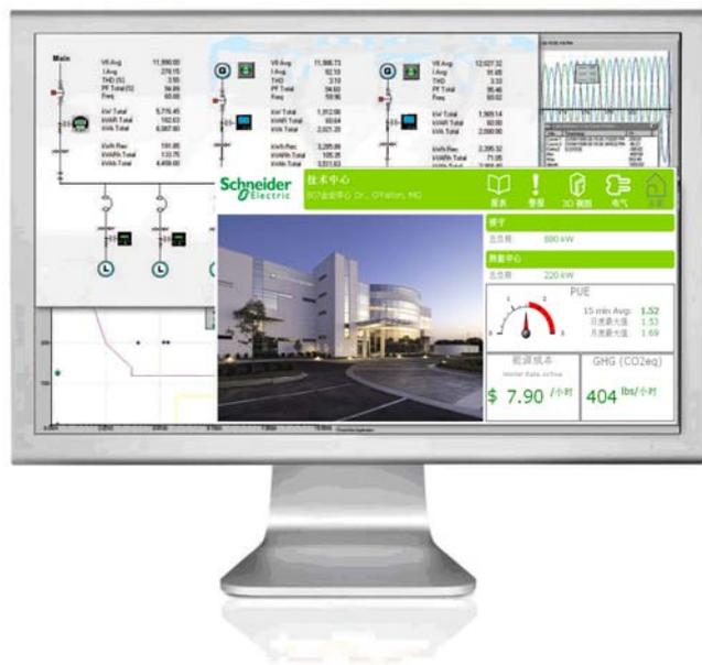
PUE监测软件模块是基于能效管理平台ION Enterprise上的扩展应用，利用其强大的功能，对数据中心能耗指标进行监测分析，指导用户，提高管理效率。
