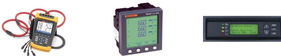
制冷和电源设备中永久安装的 内置功率测量功能 (APC Symmetra UPS)
