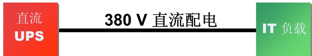
图 2 展示了第二种选择。这是一种假想的 380 V 直流配电方法。为使这一假设成立，需要设计出以 380 V 直流电运行的 IT 设备。文献中曾针对这种系统提出了多种不同的直流电供电电压，例如 300 V、380 V、400 V 和 575 V。但是，文献资料逐渐就此问题达成一致，认为应将 380 V 左右的电压作为首选标准，本白皮书中的分析就是基于 380 V 的直流系统。请注意，对于同一系统而言，380 V 直流电和 400 V 直流电是两个根本不同的概念。
