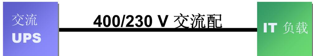
图 1 表示第一种选择。这是在北美和日本之外普遍采用的一种交流配电系统。请注意，在目前北美地区标准的配电系统中，UPS 电压为 480 V 交流电，因此图示中应添加另一个图块，以表示将 480 V 交流电转换为 208/120 V 交流电的 PDU 变压器。此图中略去了 PDU 变压器及其关联的损耗，因为在向 230 V 的 IT 负载供电时，没有必要降低 UPS 的输出电压。
